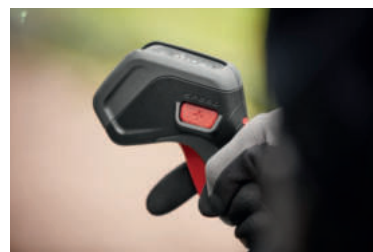
Integrovaná pojistka dlaně pro větší bezpečnost.
